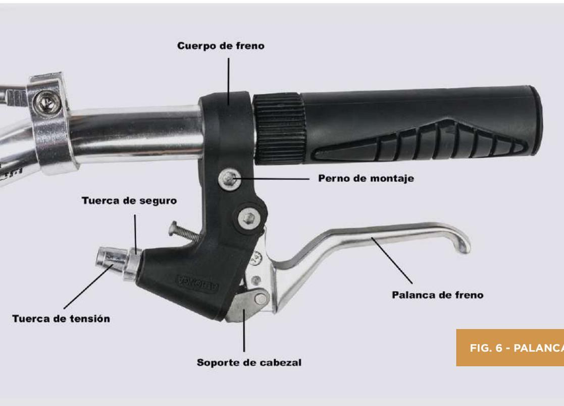
FIG. 6 - PALANCA DE FRENO
