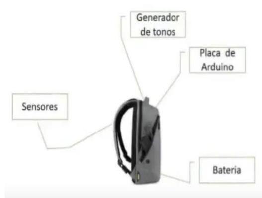
La información recogida nos sirvió para reubicar la placa arduino cerca de la batería y mejorar la ubicación de los sensores.
